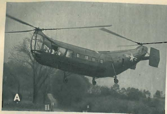
● La formula del birotore a tandem ha permesso alla Piasecki felici realizzazioni, fra cui la famosa banana volante (A) che trasporta 10 uomini,
