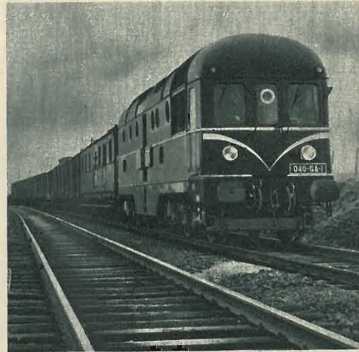
● Locomotiva Renault da 1000 cav in prova sulla linea Montparnasse-Versailles (9-7-1952), che rimorchia un treno di 200 tonnellate. Provvista di un generatore a stantuffi liberi e di una turbina a gas, questa recente macchina ha un rendimento termodinamico del 33%, e consuma nafta leggera.
