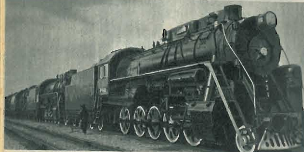
● Locomotiva a vapore 2-10-0, serie L, fabbricata a Kolomna e studiata per il traffico sui binari restaurati.
